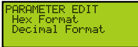
Figure 69: PARAMETER EDIT Menu – Hexadecimal or Decimal Format
